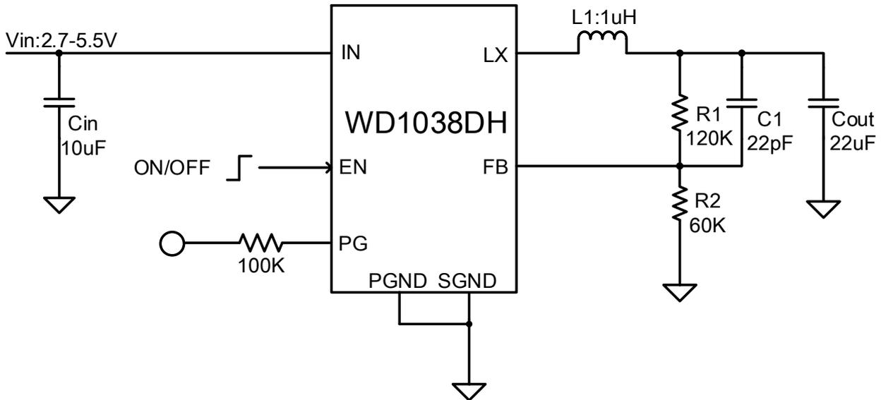
Fig1 Schematic Diagram
